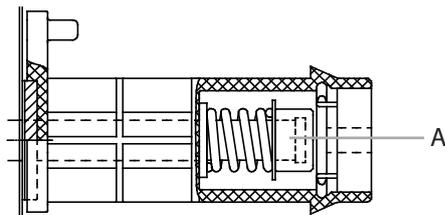
La regolazione della forza frenante avviene agendo con un cacciavite sulla vite di controllo (A) attraverso il foro presente nel dispositivo di bloccaggio del mozzo del rocchetto.
